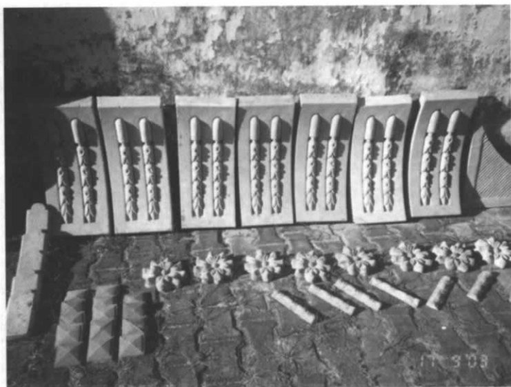
Figura i. Ornatos feitos por moldagem no canteiro de obras. (2003)
